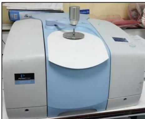
Figure (17) : Spectrophotomètre Infrarouge à transformée de Fourier (FTIR).
