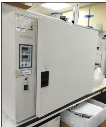
Figure (20) : Etuve chimique ventile (NUVE/FN500).
